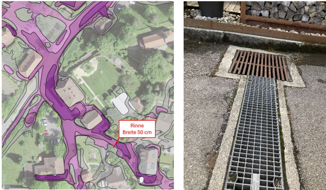
Abbildung 13: Ausschnitt Gefährdungskarte Oberflächenabfluss im Bereich Chemin St. Jean ab Parzellen 269/55. Entwässerungsrinne der Strassenentwässerung.
