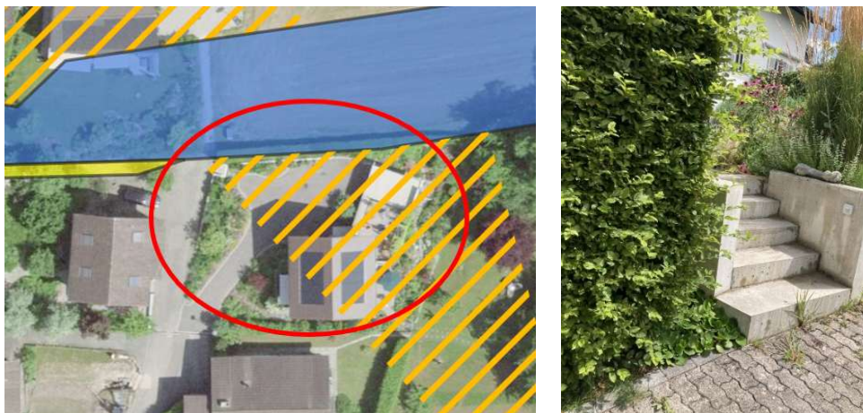
Abbildung 9: Links: Ausschnitt aus Gefahrenkarte Hochwasser mit Lage der Parzelle 50. Rechts: Mauer entlang Nordgrenze der Parzelle 50 (Objektschutzmassnahme).
